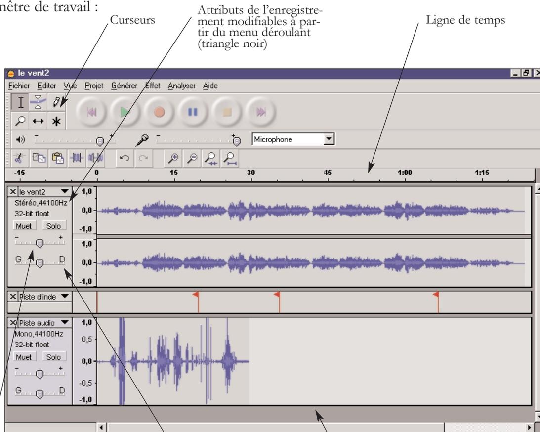
Réglage du gain (ce réglage est différent de celui du volume car il modifie le niveau d'enregistrement, attention donc à la saturation)
